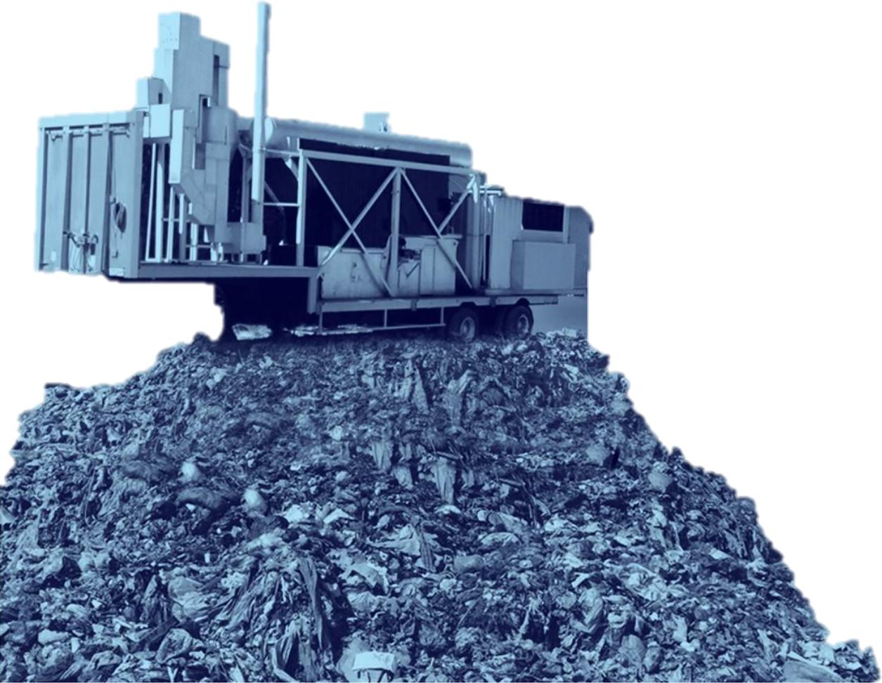
المحطة هي أول نموذج لتوليد الطاقة الكهربائية عبر معالجة النفايات عن طريق نظام التفكك الحراري. الذي هو بدوره أسلوب للتخلص من النفايات يخفض 85-90% من حجم النفايات ويحول الباقي الى رماد.
