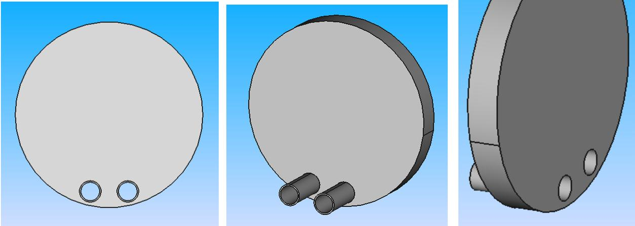
**d) Electrolysis step 1, 2 & 3 Gasket**
